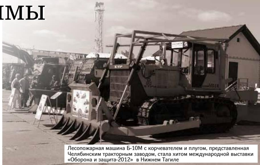
Лесопожарная машина Б-10М с корчевателем и плугом, представленная Челябинским тракторным заводом, стала хитом международной выставки «Оборона и защита-2012» в Нижнем Тагиле
